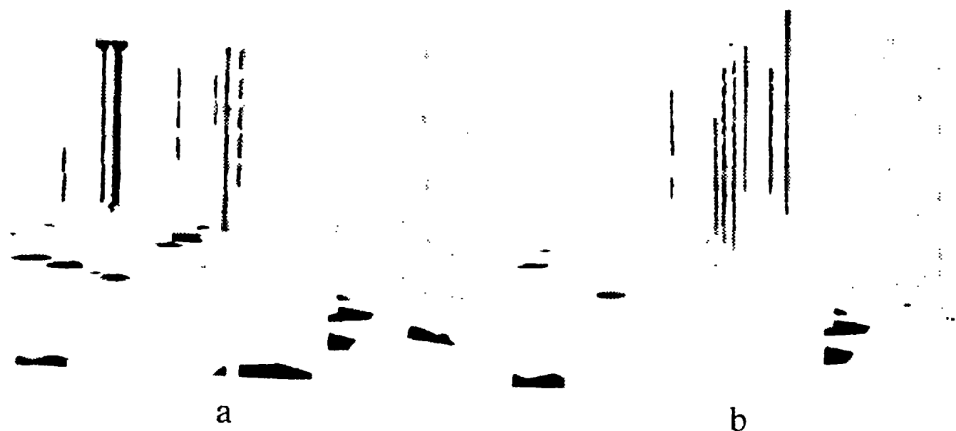
Рис. 2.54. Изображения с высоким разрешением, выводимые в растре 256 \times 256 и полученные с помощью равномерного усреднения из (а) растра 512 \times 512 , (b) растра 1024 \times 1024 . (С разрешения Ф. Кроу.)
